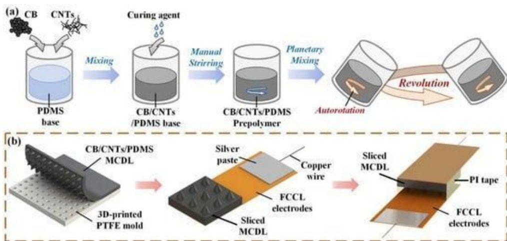
Figura 9.4 Fabricación de sensores capacitivos flexibles [6] sensores de presión basados en CB/CNT/PDMS [7].
