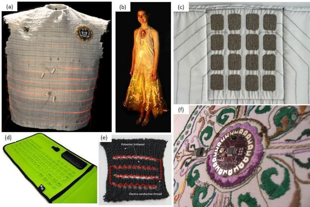
Figura 1.2 Varios tejidos inteligentes; (a) GTWM. Reproducido con permiso [8]. Copyright © 2002, ACM. (b) Vestido Firefly. Reproducido con permiso [10]. Copyright© 2000, International Business Machines Corporation. (c) Sensor de presión textil con 16 elementos sensores bordados con hilo conductor. Reproducido con permiso [11]. Copyright© 2006, IEEE proceedings. (d) Teclado textil Eleksen para blackberry rim [12]. Licencia Creative Commons BY-NC-SA 2.0. (e) Sensor de hominididad Textronic [13]. (f) Un chip microcontrolador Lillypad Arduino integrado en un textil [14]. licenciado bajo Creative Commons BY-NC-SA 2.0
