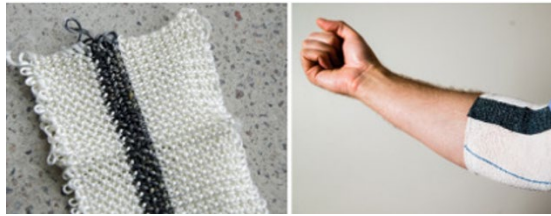
Figura 10.1 Polímeros electroactivos basados en músculos artificiales [11].
