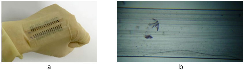
Figura 6.1 a - Generador termoelectrico PEDOT:PSS incrustado en un guante para la generacion de electricidad mediante el calor del cuerpo humano. Eun Jin Bae et al., CC BY 4.0, via Wikimedia Commons; b - Hilo de cinta piezoelectrico de PVDF (2,5x). Ptosky, CC BY-SA 4.0, via Wikimedia Commons.
