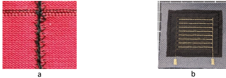
Figura 9.7 Sensores de presión resistivos: a - sensor de presión de punto basado en hilos piezoresistivos [10]; b - sensor de presión resistivo bordado [11].
