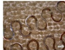
Figura 14.8 Determinación de la capa protectora a lo largo de las vías conductoras
