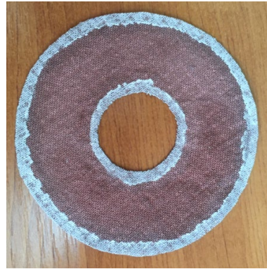
Figura 7.9 Muestra F2 para célula TEM: tela tejida con hilos conductores insertados de plata y recubrimiento de plasma con cobre.
