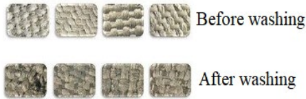
Figura 14.5 Daños en los revestimientos conductores por lavado
