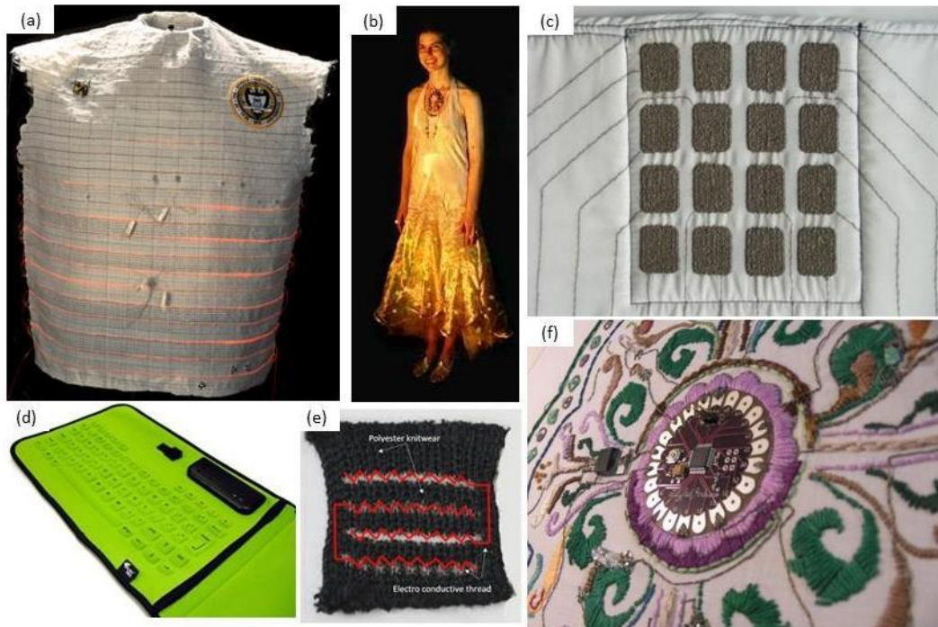
Εικόνα 1.2.2 Διάφορα έξυπνα υφάσματα. (α) GTWM. Αναπαράγεται με άδεια [8]. Copyright © 2002, ACM. (β) Φόρεμα Firefly. Αναπαράγεται με άδεια [10]. Copyright© 2000, International Business Machines Corporation. (γ) Αισθητήρας πίεσης υφασμάτων με 16 αισθητήρια στοιχεία κεντημένα με αγώγιμο νήμα. Αναπαράγεται με άδεια [11]. Copyright© 2006, IEEE proceedings. (δ) Υφασμάτινο πληκτρολόγιο Eleksen για rim blackberry [12]. με άδεια Creative Commons BY-NC-SA 2.0. (ε) Textronic αισθητήρας ανθρώπου [13]. (στ) ένα τσιπ μικροελεγκτή Lilyypad Arduino ενσωματωμένο σε ύφασμα [14]. με άδεια Creative Commons BY-NC-SA 2.0
