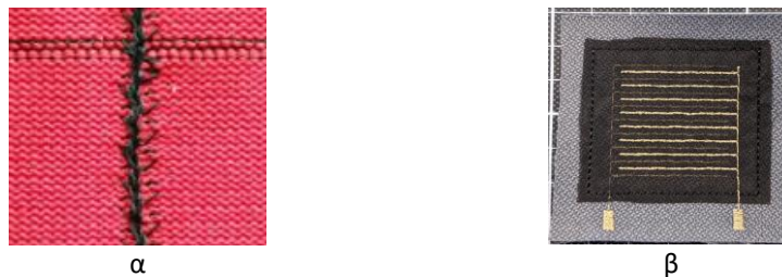
Εικόνα 9.7 Αισθητήρες πίεσης αντίστασης: α – πλεκτά πιεζοαντιστικά νήματα με βάση αισθητήρα πίεσης [10]. β – κεντημένος αισθητήρας πίεσης αντίστασης [11]
