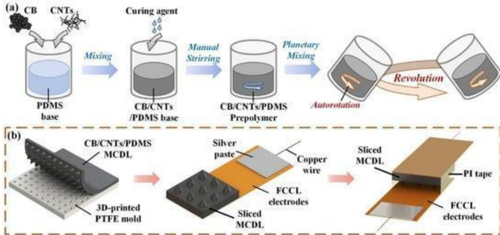
Εικόνα 9.4 Κατασκευή ευέλικτων χωρητικών αισθητήρων [6] αισθητήρες πίεσης βασισμένοι σε CB/CNT/PDMS [7]
