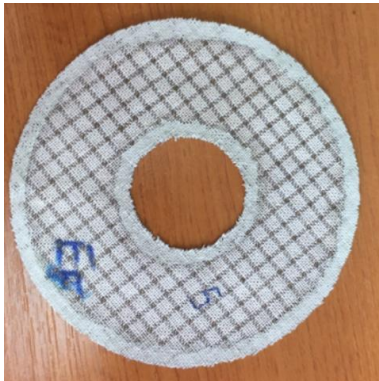
Εικόνα 7.8 Δείγμα F1 για κυψέλη TEM: υφαντό ύφασμα με ένθετα αγωγίμα νήματα από ασήμι
