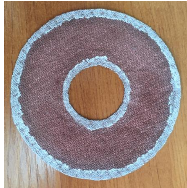
Εικόνα 7.9 Δείγμα F2 για κυψέλη TEM: υφαντό ύφασμα με ένθετα αγωγίμα νήματα από ασήμι και επίστρωση πλάσματος με χαλκό.
