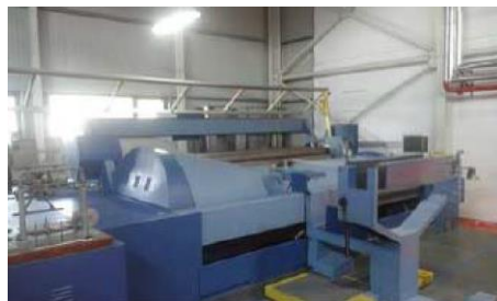
Εικόνα 7.4 Δοκός στημονιού για την εισαγωγή μεταλλικών νημάτων στη δομή στημονιού
