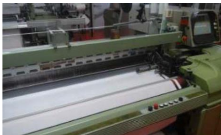
Εικόνα 7.3 SOMET αργαλειός ύφανσης για την εισαγωγή μεταλλικών νημάτων SC Majutex SRL
