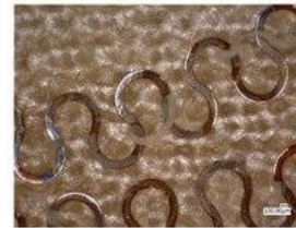
Εικόνα 14.8 Προσδιορισμός προστατευτικού στρώματος κατά μήκος αγώγιμων τροχιών
