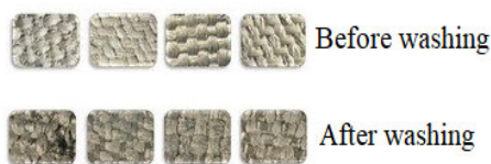
Figura 14.5 Danni ai rivestimenti conduttivi dovuti al lavaggio
