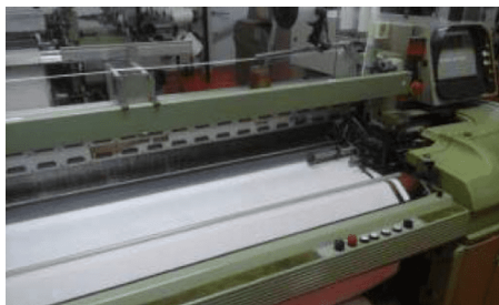
Figura 7.3 Telaio per tessitura SOMET per l'inserimento di filati metallici SC Majutex SRL
