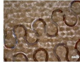
Figura 14.8 Determinazione dello strato protettivo lungo le piste conduttive
