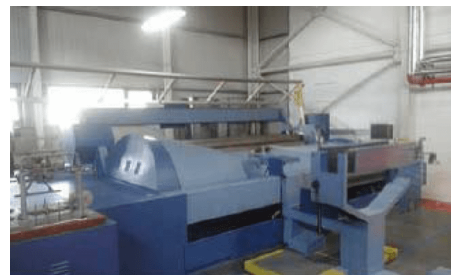
Figura 7.4 Subbio di ordito per l'inserimento di fili metallici nella struttura dell'ordito
