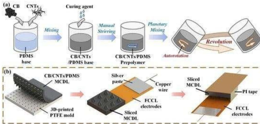
Figura 9.4 Fabbricazione di sensori capacitivi flessibili [6] sensori di pressione basati su CB/CNT/PDMS [7]
