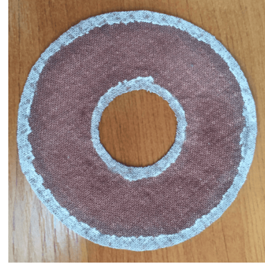
Figura 7.9 Campione F2 per cella TEM: tessuto intrecciato con fili conduttivi inseriti di argento e rivestimento al plasma con rame.
