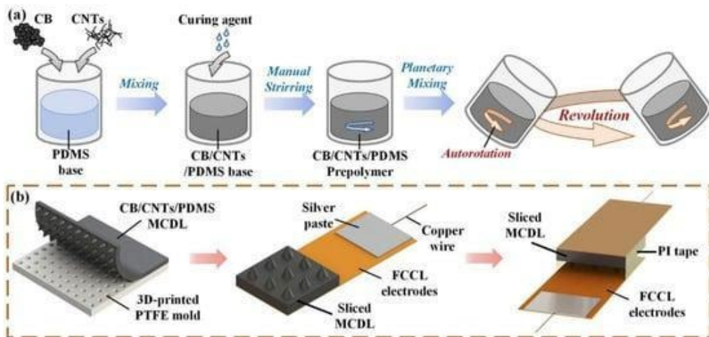
9.4 paveikslas. Lanksčių talpinių jutiklių gamyba [6] slėgio jutikliai, pagrįsti CB/CNT/PDMS [7]
