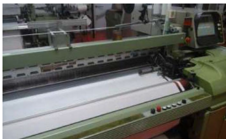
7.3 paveikslas SOMET audimo staklės metaliniams siūlams įterpti SC Majutex SRL
