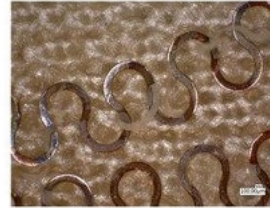
14.8 paveikslas. Apsauginio sluoksnio nustatymas išilgai laidžių takelių
