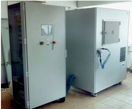
7.5 paveikslas. INCDTP žemo slėgio plazminė įranga
