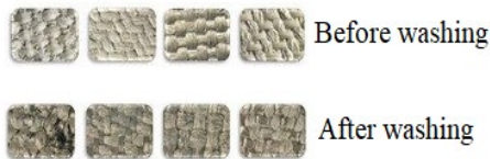
14.5 paveikslas. Laidžių dangų pažeidimai skalbiant
