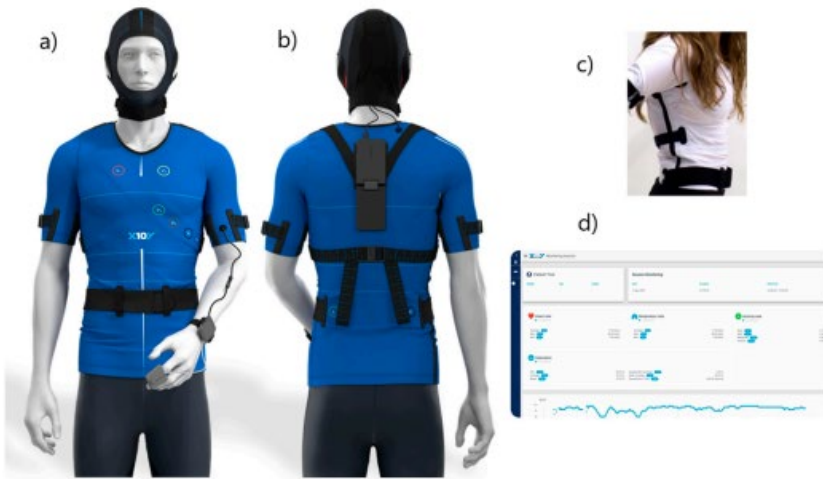
Figura 18.4. (a) Vistas frontal y posterior de la prenda de compresión médica de L.I.F.E. (BWell). La vista posterior (derecha) muestra dónde se coloca el tapón cuando se lleva puesta la prenda. Ambas vistas muestran un tapón para realizar EEG que la empresa está desarrollando actualmente. (c) Un ejemplo del ajuste de BWell cuando se lleva puesta. (d) Panel de visualización de datos en tiempo real. La figura se ha adaptado de la página web de la empresa que fabrica la prenda. [13]
