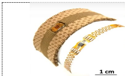
a. Sensores integrados en prendas de punto para controlar la temperatura, la respiración y la frecuencia cardíaca (e-TECS) [7].
