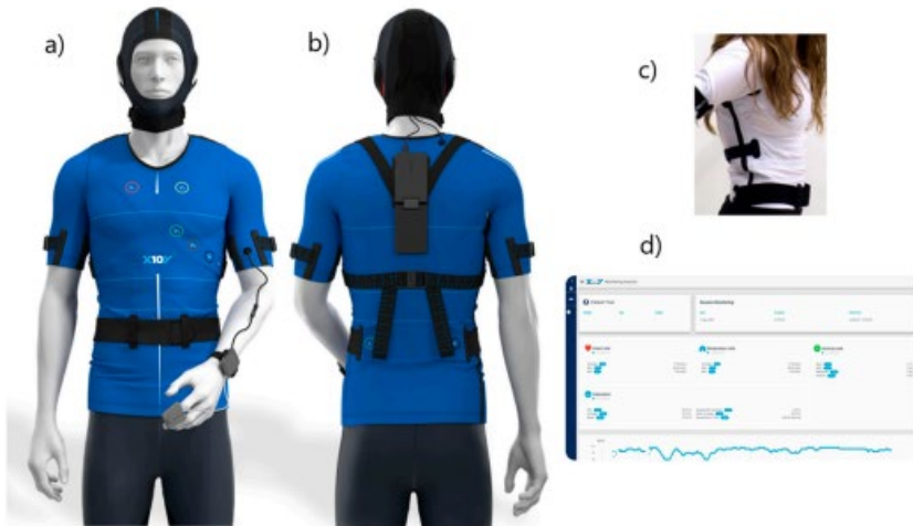
Figure 18.4. L.I.F.E. medicininio kompresinio drabužio vaizdas priekyje a) ir b) gale (BWell). Užpakalinis vaizdas (dešinėje) rodo, kur kištukas įkištas, kai drabužis dėvimas. Abu vaizdai rodo EEG atlikimo ribą, kurią šiuo metu kuria įmonė. (c) BWell tinkamumo dėvėjimo pavyzdys. (d) Realaus laiko duomenų vizualizavimo programa. Figūra buvo pritaikyta iš drabužių gaminančios įmonės interneto svetainės. [13]
