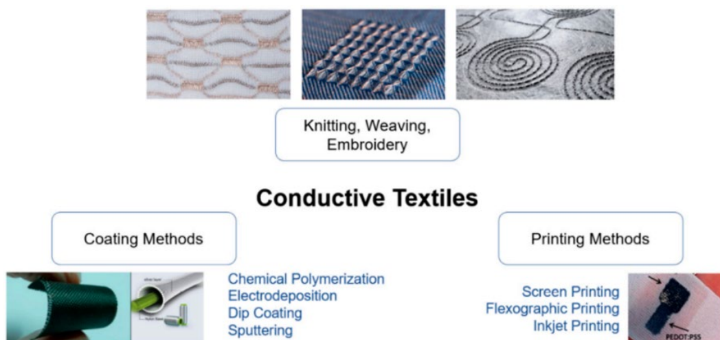
Figura 10.1. Tehnici de fabricare a textilelor conductive: tricotare, țesere, brodare; tratamente de acoperire; imprimare [3]
