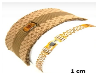
a. Senzori integrați în tricot pentru monitorizare temperatură, respirație și ritm cardiac (e-TECS) [7]
