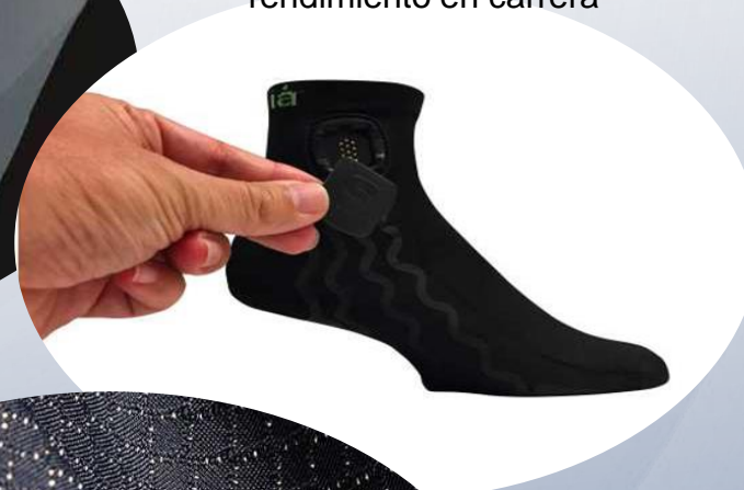
Calcetines inteligentes Sensoria: sensores textiles que detectan parámetros importantes para el rendimiento en carrera
