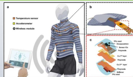
Tuta conformabile in tessuto elettronico (E-TECS) per il rilevamento distribuito in modalità wireless
