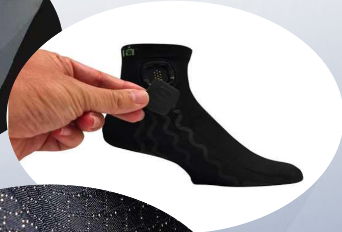
Calzini intelligenti Sensoria: sensori tessili che rilevano parametri importanti per le prestazioni di corsa
